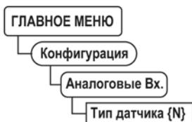
Заводскими настройками для аналоговых входов с 1 по 6 установлен тип датчика – **50M**.
